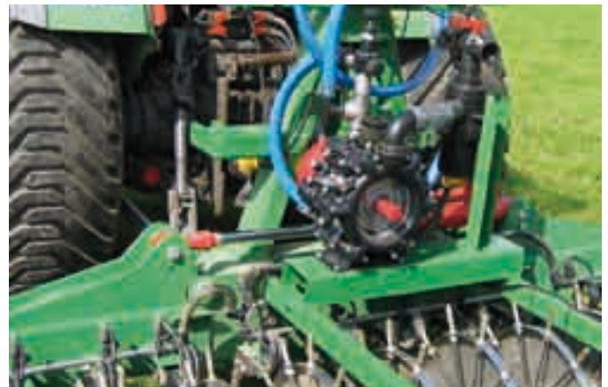
La pompe à membrane et la soupape de régulation de l'appareil d'injection sont commandées par un microprocesseur. La quantité souhaitée peut ainsi se régler indépendamment de la vitesse de travail. Le marquage à la mousse sur les extrémités des roues permet un départ précis dans n'importe quelle condition.
