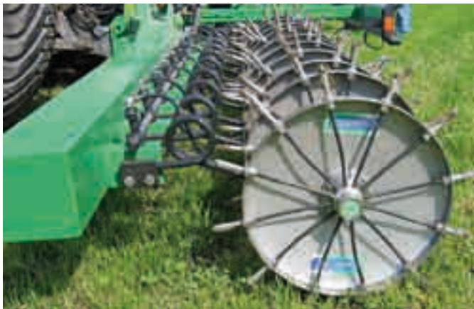
Roue d'injecteur pour l'application ponctuelle d'ammonium dans les cultures à rangs serrés et les prairies. Les raccords d'injection en forme d'étoile sont fermés à leur extrémité. Le liquide sort par des ouvertures latérales au moment où les tubes pénètrent dans le sol. Grâce à une fixation pendulaire et une compression à ressort des agrégats individuels, une profondeur régulière est assurée.
