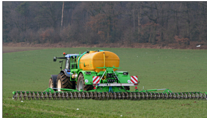
Mit einer solchen gezogenen 12-m-Injektions-Maschine will Briner die Cultan-Düngung ausbauen. (Bild: zvg)
